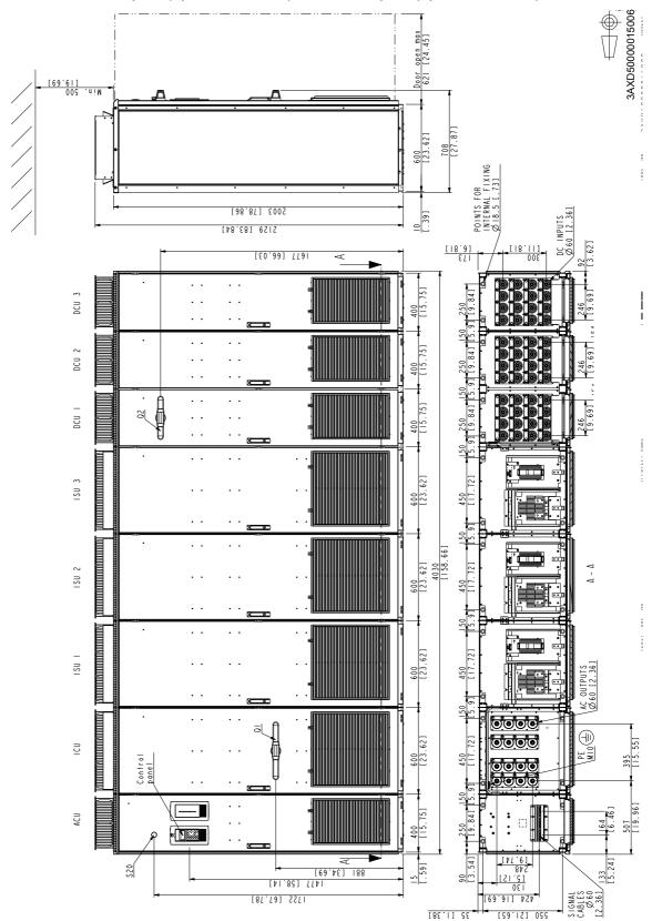
3 × R8i – 12 DC inputs (option +12H382) or 15 DC inputs (option +15H382):
